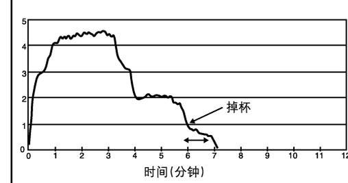
落。例2就是一个典型的因为重复安装挤奶器造成的奶产量以及流速受到严重影响的情况。在牛奶流速很低（低于2.2磅/分）时挤奶器会被牛踢掉。在增加了挤奶前刺激时间和挤奶前准备一滞后时间后，以及随时间调整脱杯装置后，我们回访农场时发现很少再有牛踢掉挤奶器的情况，低速奶流的时间也减少了。
